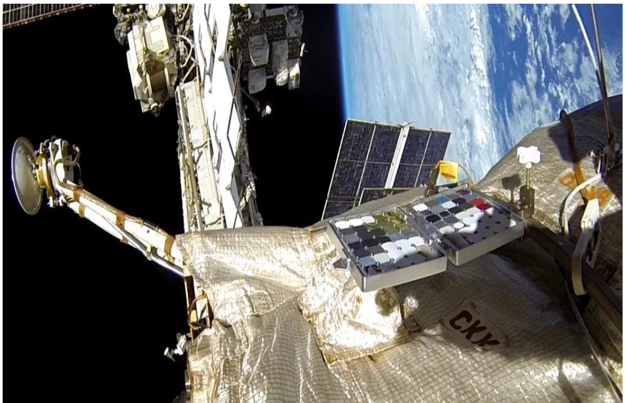
Рис. 5.3 – Съемная кассета с экспериментальными образцами материалов раскрыта и установлена на экспонирование
