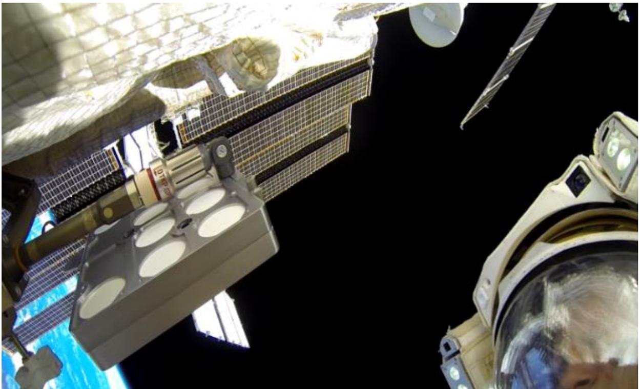
Рис. 5.2– С кассеты СКК снят защитный чехол
