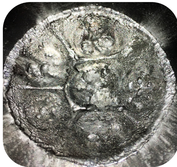
Рисунок 3.21. Фотография пластин-свидетеля после взрыва ПВГС с заполненными каналами пороховых элементов
