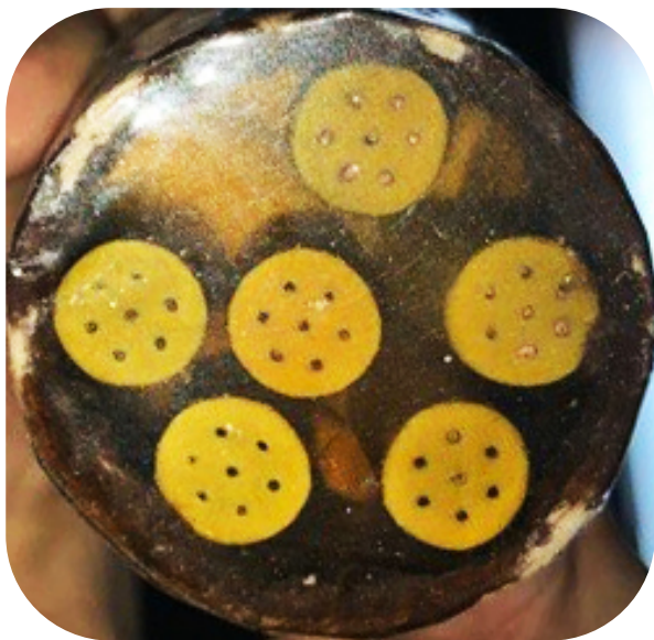
Рисунок 3.20. Фотография торца заряда ПВГС на основе ПП марки 14/7 с заполненными каналами пороховых элементов
