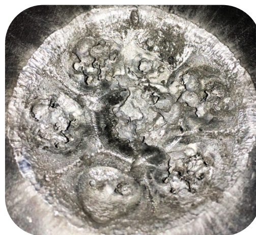
Рисунок 3.19. Фотография пластины-свидетеля после взрыва ПВГС
