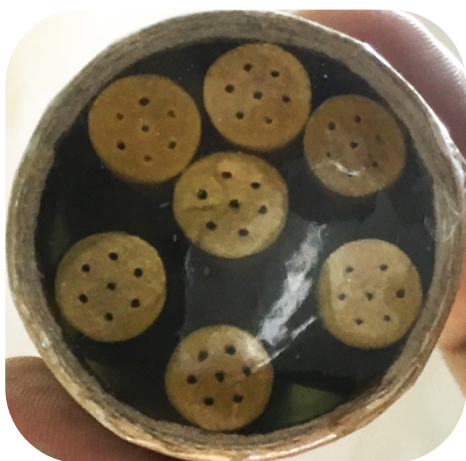
Рисунок 3.18. Фотография торца заряда ПВГС на основе ПП марки 14/7
