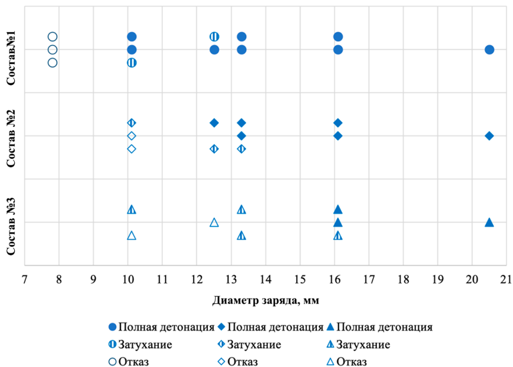
Рисунок 3.13. Результаты определения критического диаметра детонации для ПВГС на основе водных гелей различного химического состава
