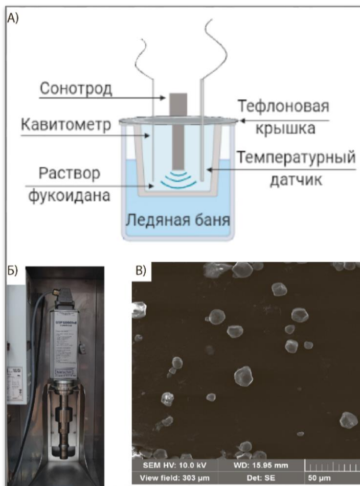
Рисунок 10 – Схема получения образцов (А) и изображение применяемой ультразвуковой установки (Б);
