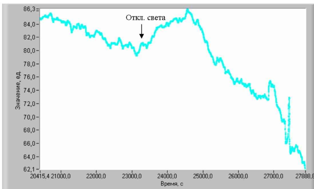
Рисунок 5.11 – Отклик датчика растворенного кислорода в биореакторе на отключение света при УФ-облучении суспензии биореактора.
