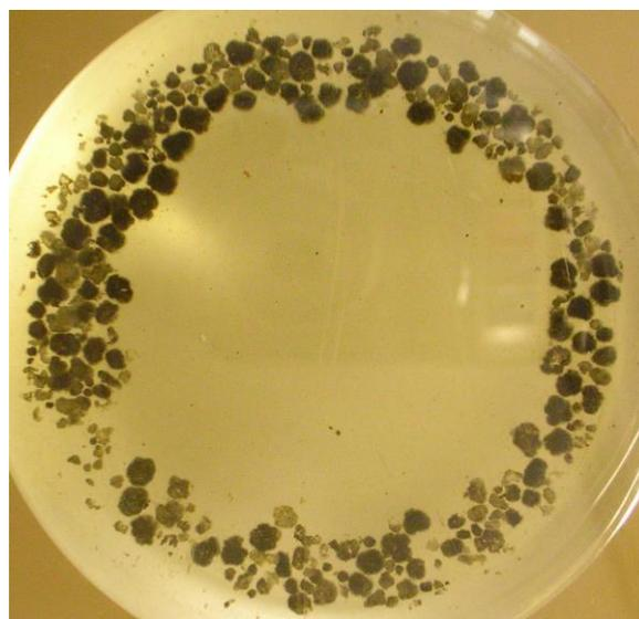
Гранулы ила, образованные при очистке в колбе без внесения  $H_2O_2$
