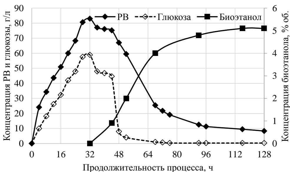
Рисунок 3.19 – Зависимости концентраций РВ и биоэтанола от продолжительности ферментативного гидролиза и спиртового брожения
