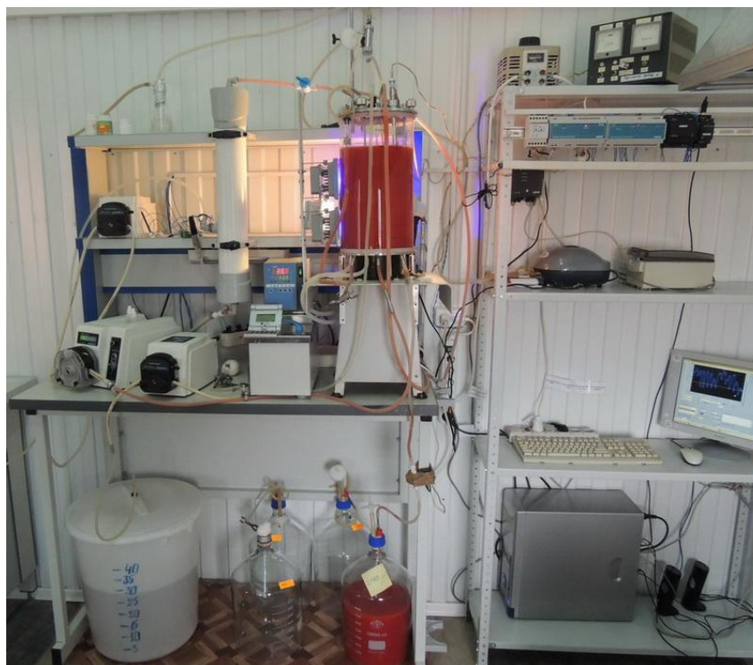
Рисунок 3.16. Пример комплектации автоматизированной установки для высокоплотного культивирования микроорганизмов.
