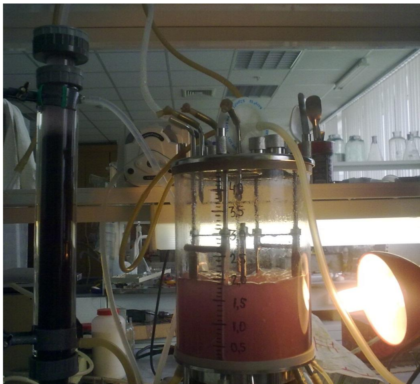
Рисунок 2.4. Биореактор с рециклом культуральной жидкости с клетками через адсорбционную колонну с адсорбентом.
