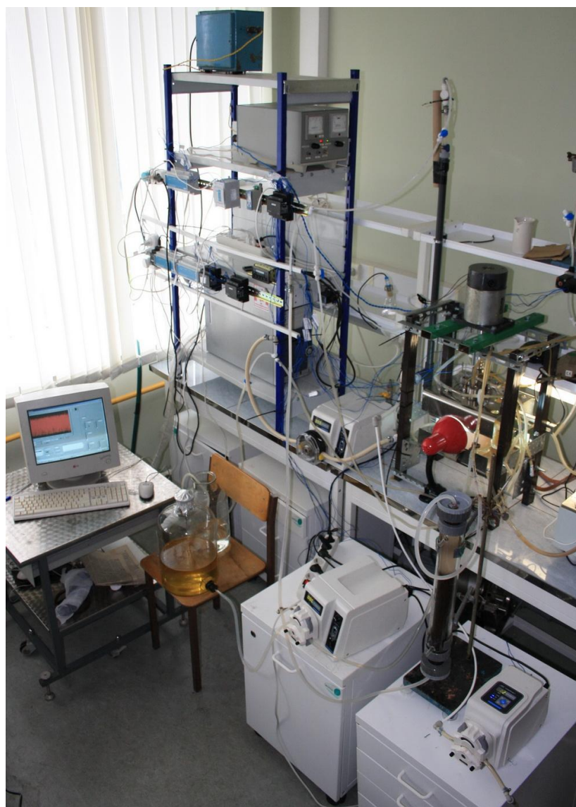
Рисунок 2.5. Полная версия автоматизированной системы культивирования Hbt. salinarum с адсорбционной колонной.
