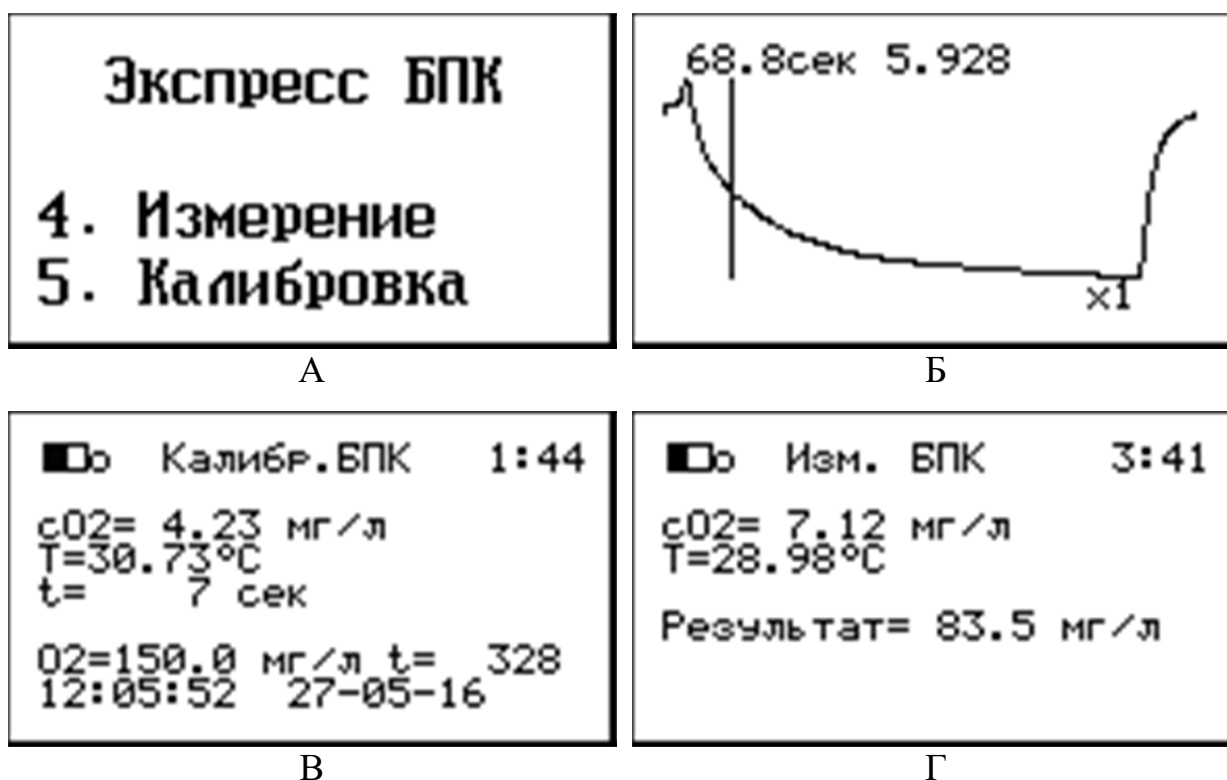
Рис. 174. Внешний вид дисплея анализатора при выполнении анализа: А – меню экспресс-определения БПК; Б – вид отклика биосенсорной системы на добавление пробы в измерительную кювету; В – вид дисплея в режиме калибровки БПК; Г – результаты измерения БПК.
