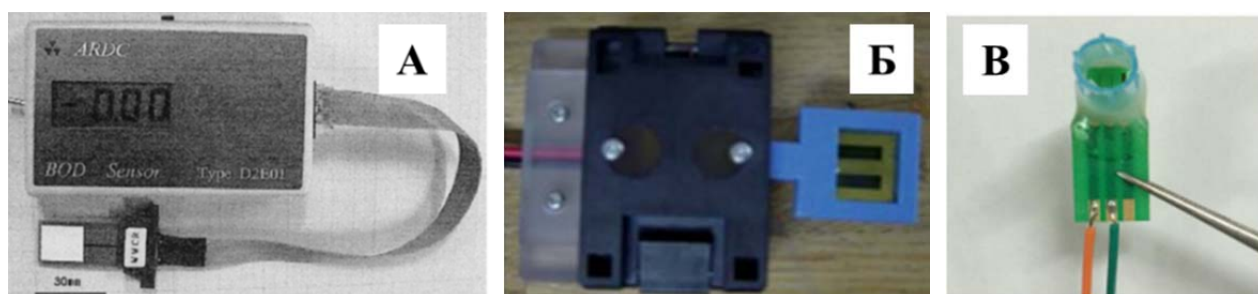
Рис. 114. Портативные биосенсорные БПК-анализаторы: А – биосенсор, описанный в работе [294]; Б – биосенсор, описанный в работе [295]; В – модифицированный электрод, описанный в работе [62].
