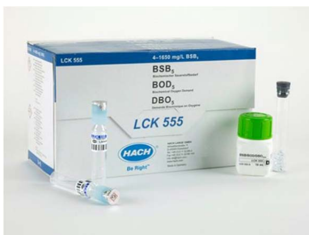
Рис. 2. Набор для кюветного теста на БПК 5 фирмы «Hach Lange», диапазон измерения 4–1650 мг/л O 2 .
