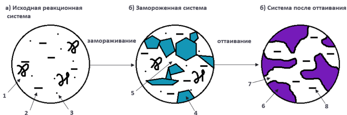
Рисунок 1. Схема процесса криотропного гелеобразования: 1 – высокомолекулярный предшественник; 2 – растворитель; 3 – низкомолекулярный предшественник; 4 – кристаллы замерзшего растворителя; 5 – незамерзшая жидкая микрофаза; 6 – полимерная фаза криогеля; 7 – макропоры; 8 – оттаявший растворитель [12].
