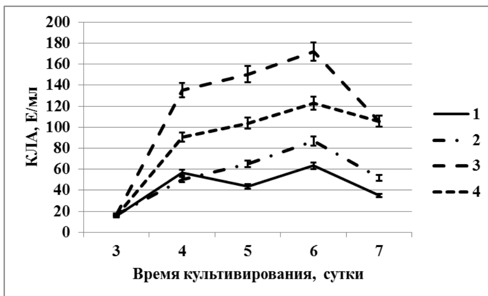
Рис. 21. Влияние количества посевного материала на секрецию коллагенолитических протеаз A. fumigatus : 1 – 10^6 ; 2 – 2,5 \times 10^6 ; 3 – 5 \times 10^6 ; 4 – 10^7 спор/мл
