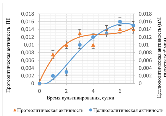
Рисунок 28. Изменение целлюлолитической и протеолитической активности в выходящем растворе при поверхностном культивировании F. oxysporum с непрерывной подачей компонентов питания.
