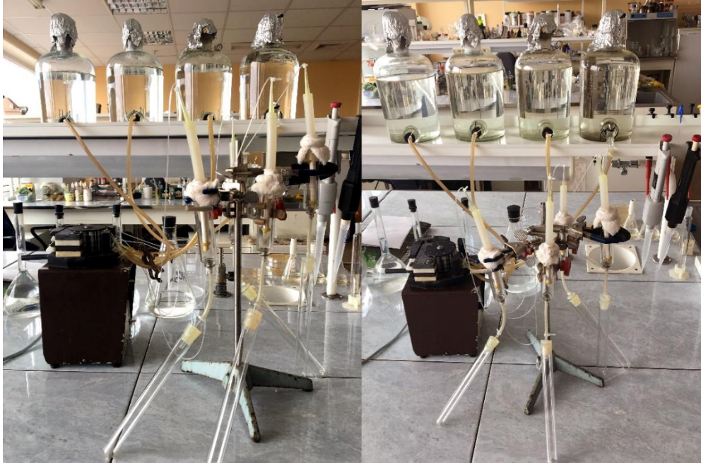
Рисунок 25 - Установка для непрерывного поверхностного культивирования микроорганизмов
