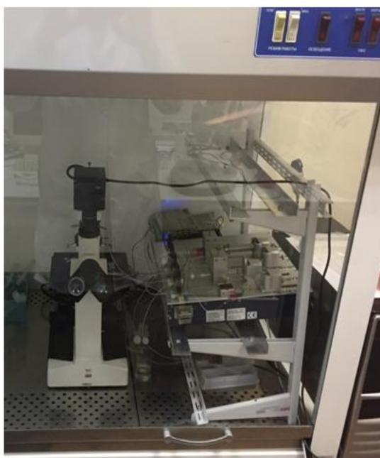
Рисунок 40 – Общий вид стендовой микрофлюидной системы в ламинарном шкафу
