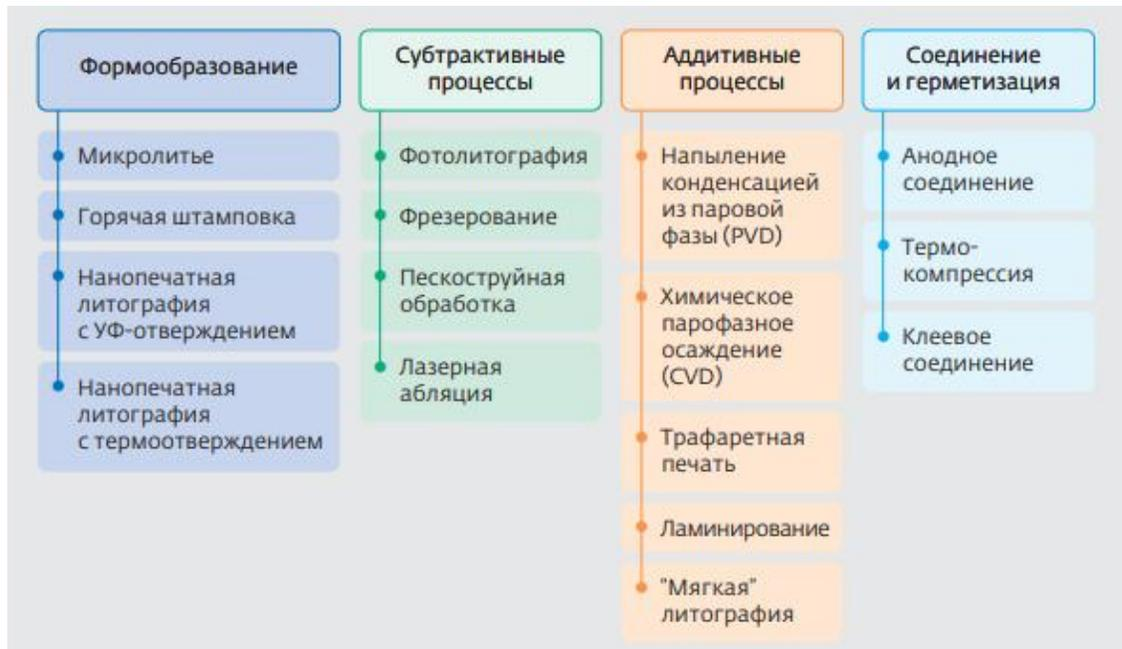
Рисунок 17 – Классификация технологий, применяемых для изготовления микрофлюидных устройств [79].
