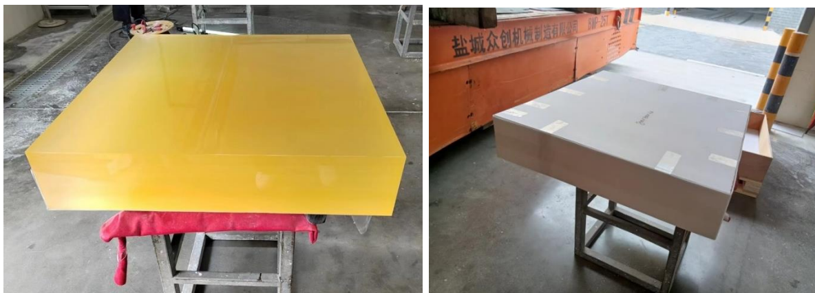
Рис. 7.25. Панель из ультранизкофонового Gd-ПММА материала, изготовленная компанией Donchamp Acrylic Co., Ltd (Китай) по базовой технологии, разработанной в рамках выполнения диссертационной работы (слева) и готовое изделие в упаковке, готовое к отправке (слева).
