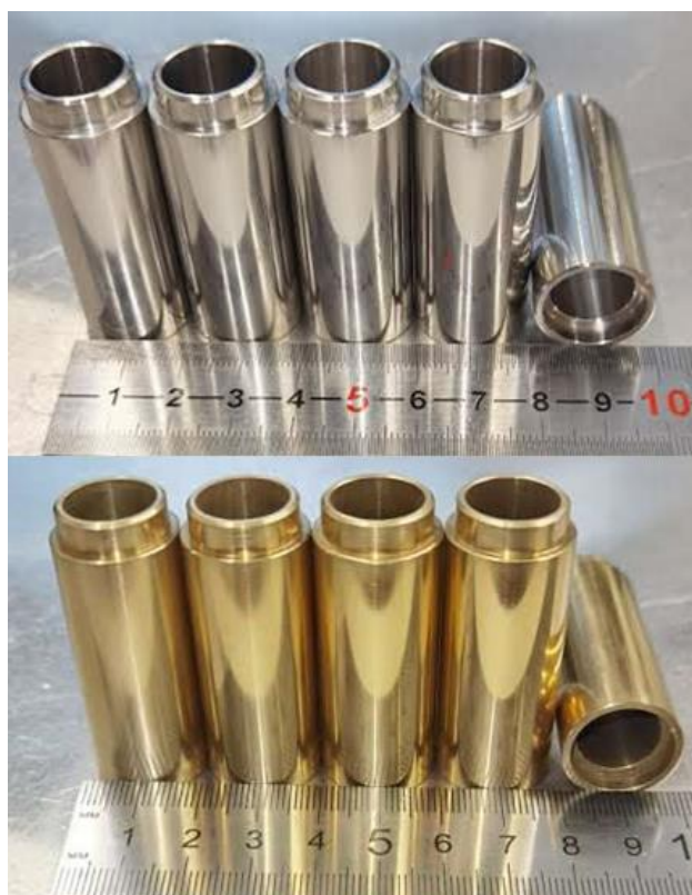
Рис. 2.96. Оснастка из полированной нержавеющей стали (сверху) с покрытием нитридом титана (снизу).
