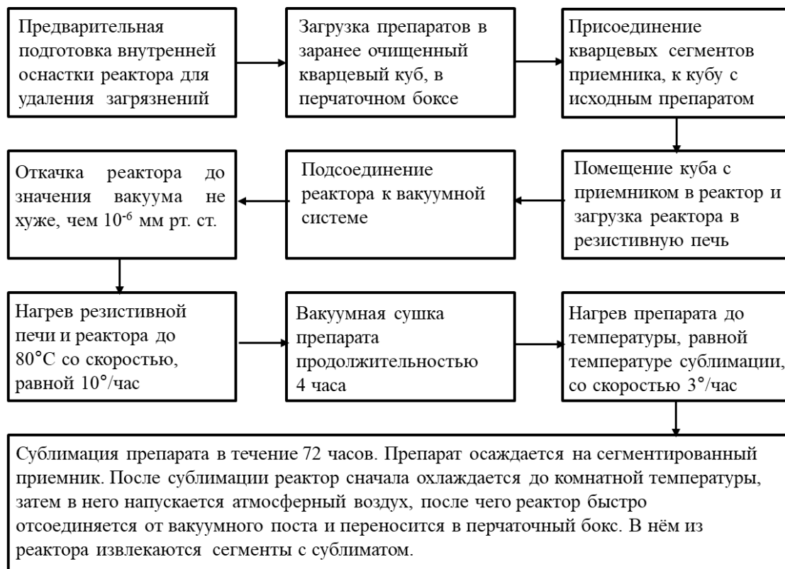
Рис. 2.90. Методика вакуумной сублимационной очистки с турбомолекулярной системой откачки.
