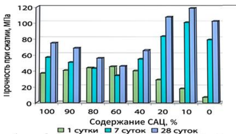
Рисунок 1.4 – Прочность композитов на основе ПЦ и САЦ с SN=1 по [85]
