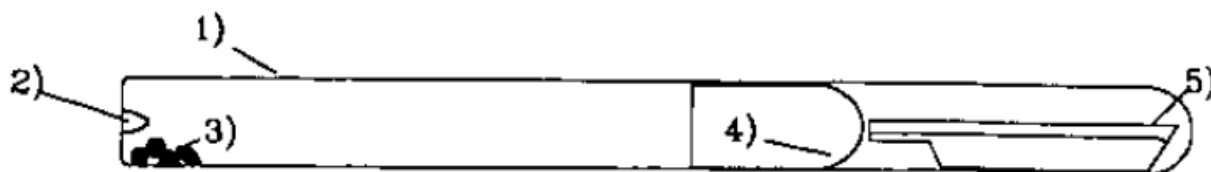
Рис. 1.17. Схематическое изображение установки, для выращивания монокристаллов GaAs методом горизонтально направленной кристаллизации Бриджмена: 1 – ампула, 2 – термодом, 3 – источник мышьяка, 4 – диффузионный барьер, 5 – кварцевая лодочка с расплавом и затравкой [74]
