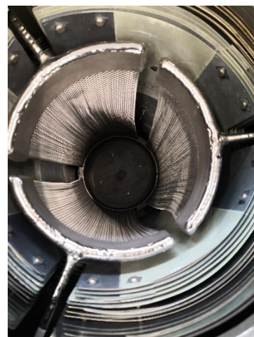
Рис. 3.18. Шахтная вакуумная электроустановка КБ-134 производства ООО «НПП МосЗЭТО»: 1 – внешний вид 2 – вид изнутри
