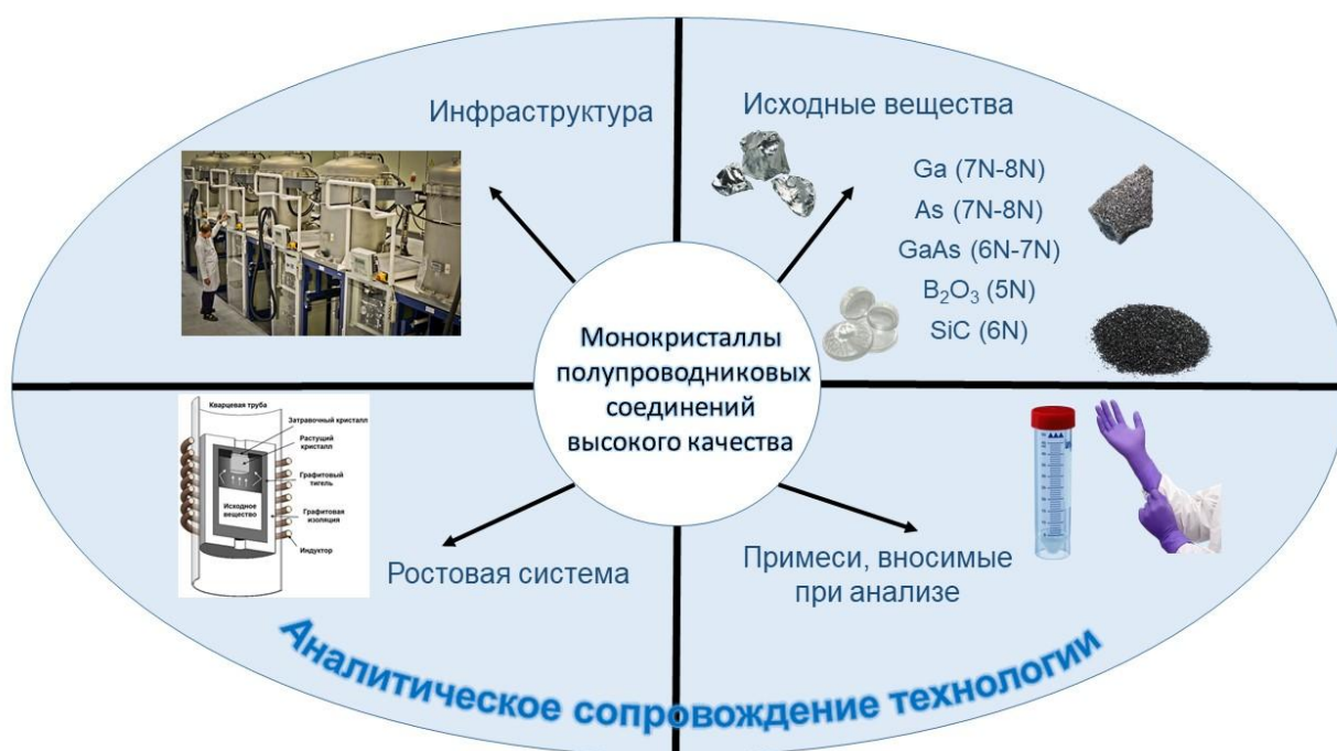
Рис. 3.24. Схема комплексного подхода к оценке химической чистоты технологических процессов получения высокочистых веществ
