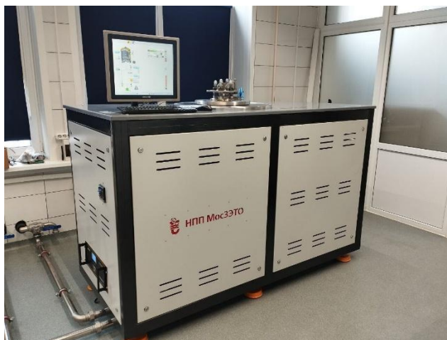
Рис. 3.18. Шахтная вакуумная электроустановка КБ-134 производства ООО «НПП МосЗЭТО»: 1 – внешний вид 2 – вид изнутри
